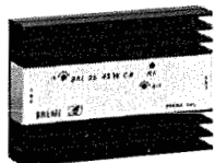
BRL 35 amplificatore lineare Potenza ingresso 0,2-4 W AM. Potenza uscita 45 W AM. Tensione alimentazione 12-15 V c.c.
